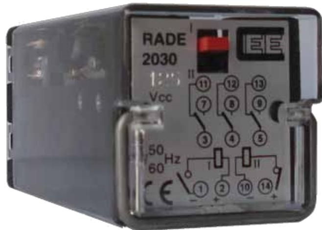
Les relais auxiliaires RADE constituent la famille CEE de relais de commande et de signalisation à réarmement électrique (bistable).
