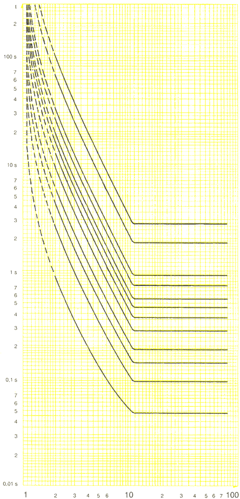
Fig. 4 : ITV7466 - Courbes à temps extrêmement inverse type C - CEI 255-4 pour 100% U_n ITV7266 - Inverse time curves to IEC 255-4 type A for 100% U_n .
